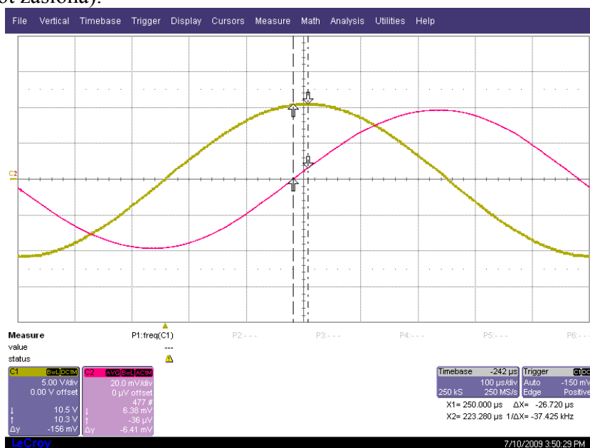
Slika 3: Določanje zakasnitve \Delta t iz maksimuma napetosti u_L in minimuma toka i_L .
